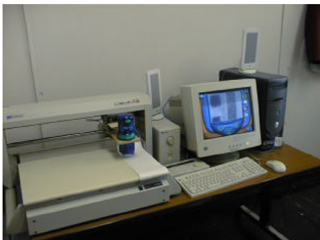
Fig.11 直線の画像読み取り装置
