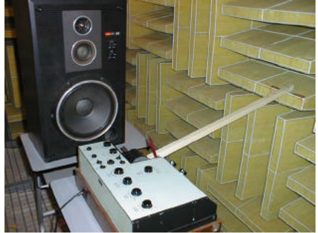
Fig.9 スピーカと線の記録装置
